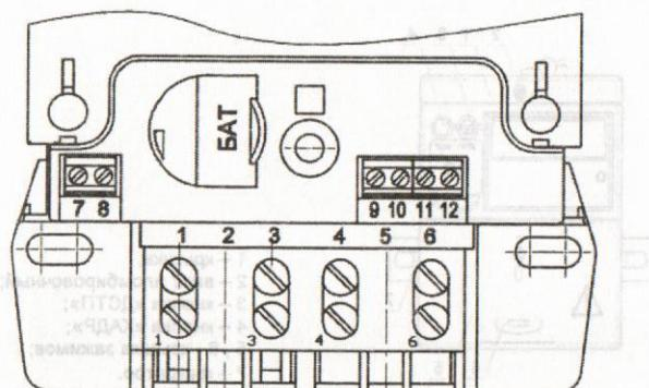
Рисунок 2.4 – Нумерация контактов счетчика СЕ102М S7
