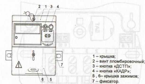
Рисунок 2.3 Внешний вид счетчика СЕ 102М R5.1
