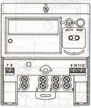
Рисунок 2.6 – Нумерация контактов счетчика СЕ102М R5.1
