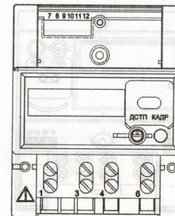
Рисунок 2.5 – Нумерация контактов счетчика СЕ102М Р5
