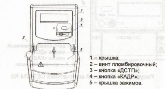
Рисунок 2.1 – Внешний вид счетчика СЕ102М S7
