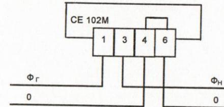
Схема включения счетчика СЕ102М R5.1
